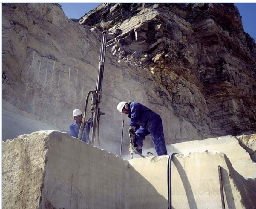
Corte de bloques en cantera del mármol de la Sierra de Filabres
