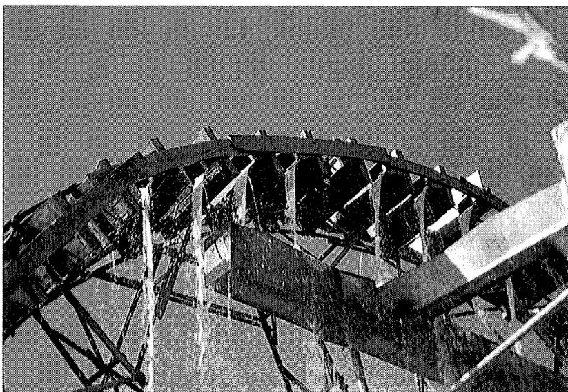
Lám. 4. Noria de Jauja en funcionamiento; en la fotografía puede apreciarse cómo se produce el vertido del agua desde los cangilones al añaquil.
